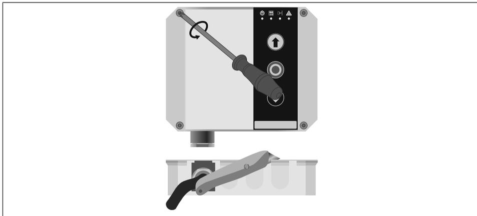
Ouvrez le couvercle de la commande. Débranchez le câble du couvercle et mettez le couvercle soigneusement de côté. Retirez les encoches nécessaires dans la partie inférieure du boîtier.
